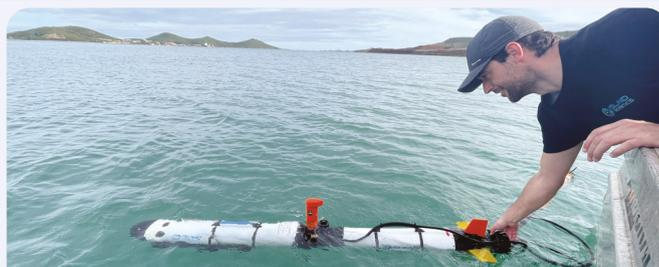
Déploiement d'un AUV petits fonds
