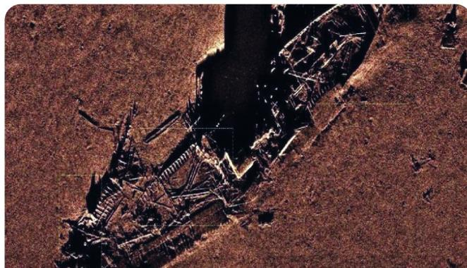
Image SAS depuis un AUV d'une épave (source Marine et Océans)
