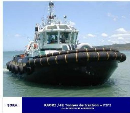
Figure 5.3.29 : exemple de remorqueur portuaire utilisé en Nouvelle-Calédonie.
