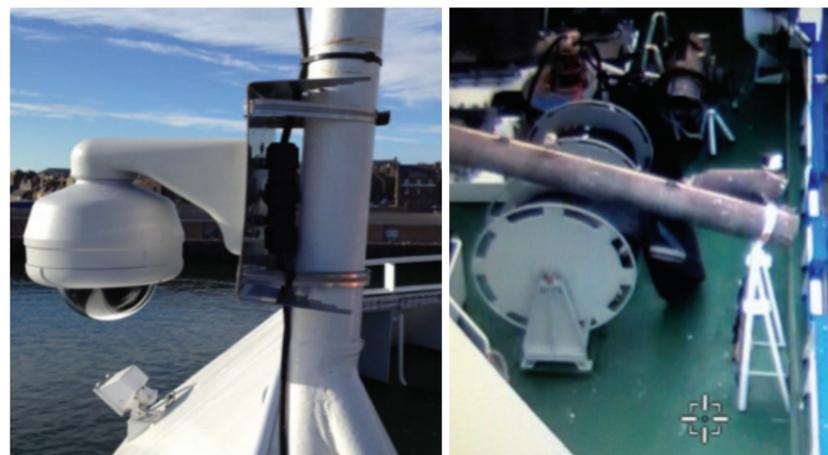
**Figure 53 :** Système EMS à bord d'un bateau de pêche (© Traceall Global).
