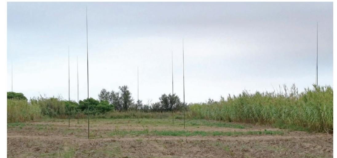
**Figure 77 :** Réseau d'antennes d'émission d'un radar HFSWR (© DigiNext).
