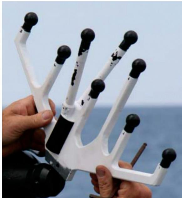
**Figure 76 :** Réseau volumétrique d'hydrophones (source : Marguer et al. 2013).
