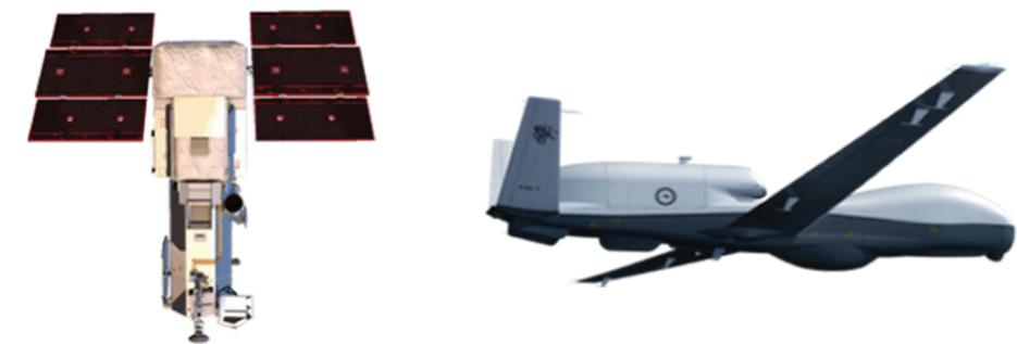
Figure 42 : à gauche, un satellite (vecteur) embarquant un radiomètre imageur (capteur) (source : DigitalGlobe) ; à droite, drone haute altitude (vecteur) embarquant un appareil photographique (capteur) (source : Aces Flying High).
