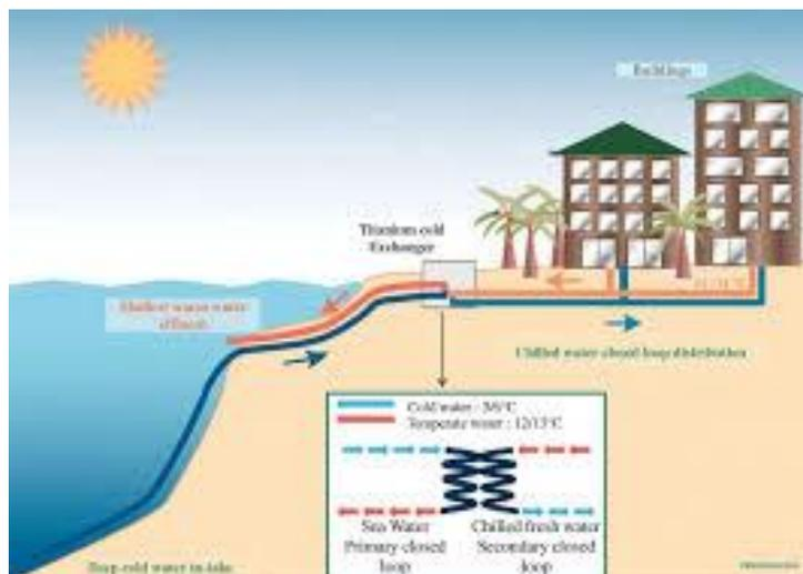
*Principe de climatisation par pompage d'eau froide en mer (Système SWAC)*
