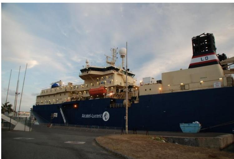
Ce navire a pour objet d'intervenir pour la pose de câbles mais aussi pour toute réparation (incident de connexion, rupture), sachant qu'un câble a environ 25 ans de vie, dans une immense zone qui va de l'Ouest et Sud Australien à Hawaï en passant par Guam et le sud-est de la Polynésie française.
