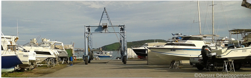
Photo 4 Travelift 15 tonnes de la Baie de Numbo
