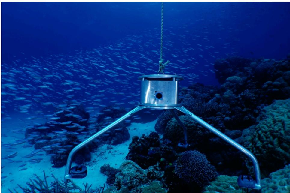
Figure 4. Système C360 développé par SQUALE. Etanchéité 2500 m.
